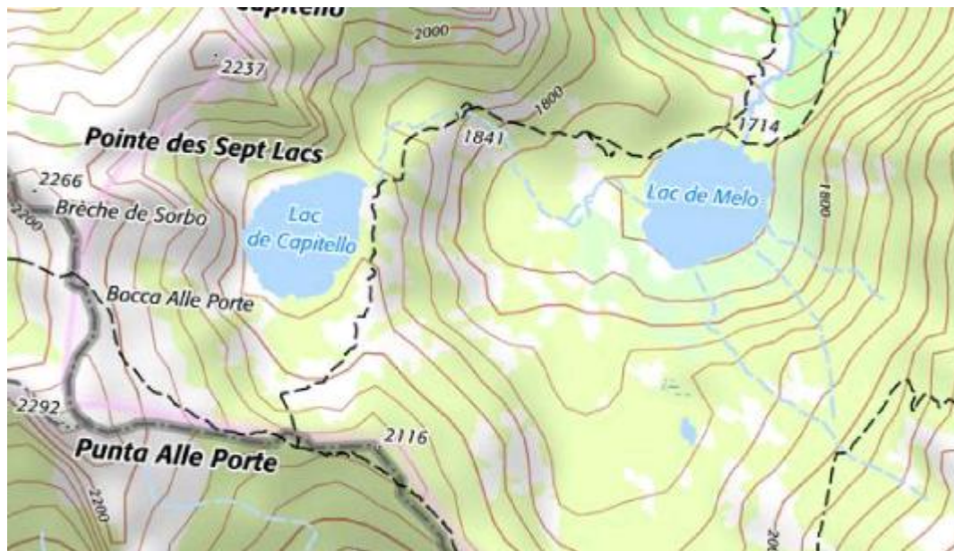
FIG. 8.4 Carte topographique autour de la pointe des Sept Lacs, au fond de la vallée de la Restonica. Les courbes de niveaux sont représentées en brun, on voit en particulier la courbe à 1800 m et celle à 2000 m.
